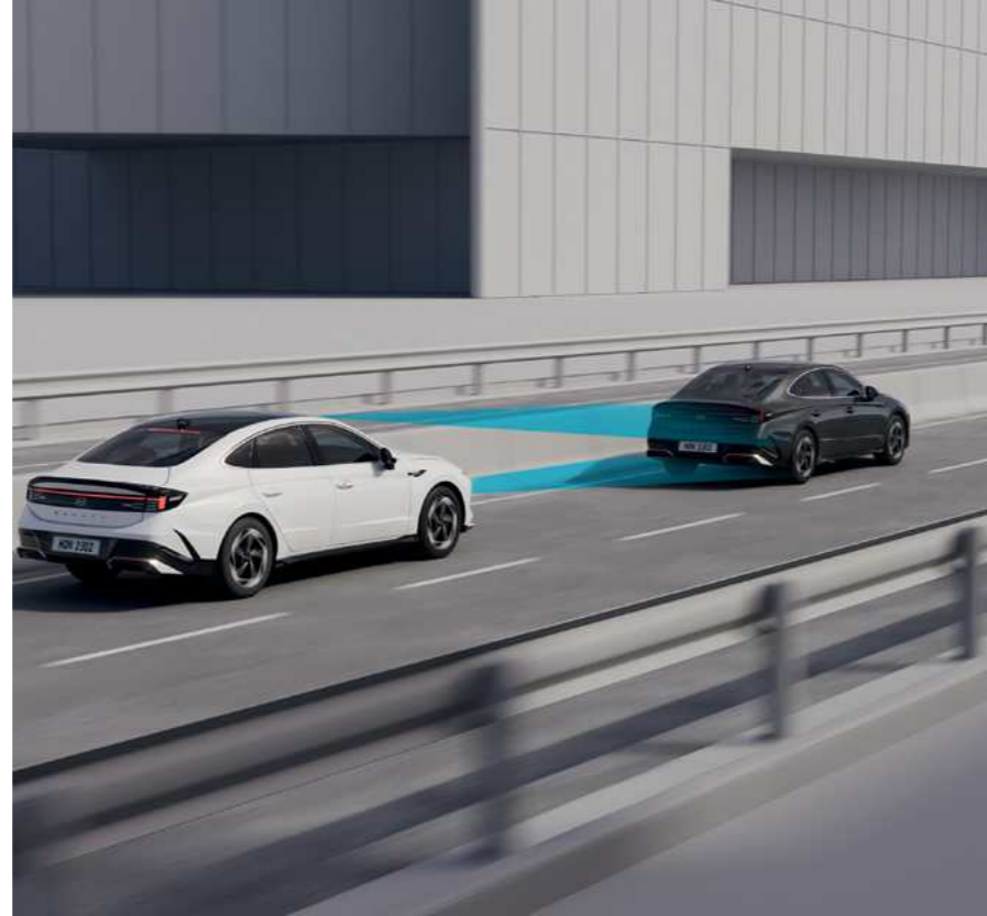
בקרת שיוט חכמה (SCC) שומרת על מהירות ומרחק קבועים מהרכב שמלפנים בעזרת חיישן רדאר ושולטת בהאצה והאטת הרכב.
