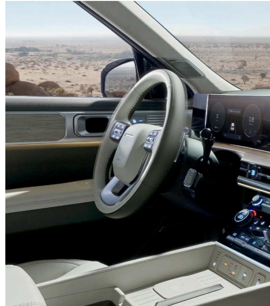
גלגל הגה רוטט - בעת נהיגה או חנייה, אם מערכת הבטיחות מזהה מצב מסוכן, ההגה רוטט ומתריע לנהג.
